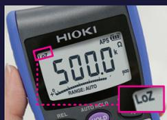
检测以 LOZ 显示，可确认电流的切换状态
