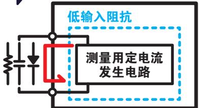
切换成电阻量程 ▶ 输入检测 ▶ 切换测量电路
